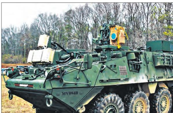
*БМ «Страйкер» с комплексом лазерного оружия «М-Мхел»*
