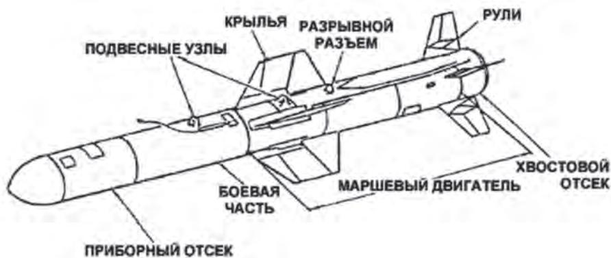
*Основные элементы конструкции противокорабельной ракеты AGM-84A «Гарпун»*
