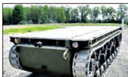
попарно заблокированных опорных катков на каждый борт. «Трэкд робот» способен работать автономно по заранее введенной в бортовой компьютер программе или управляться оператором дистанционно с использованием двусторонней линии радиосвязи.
