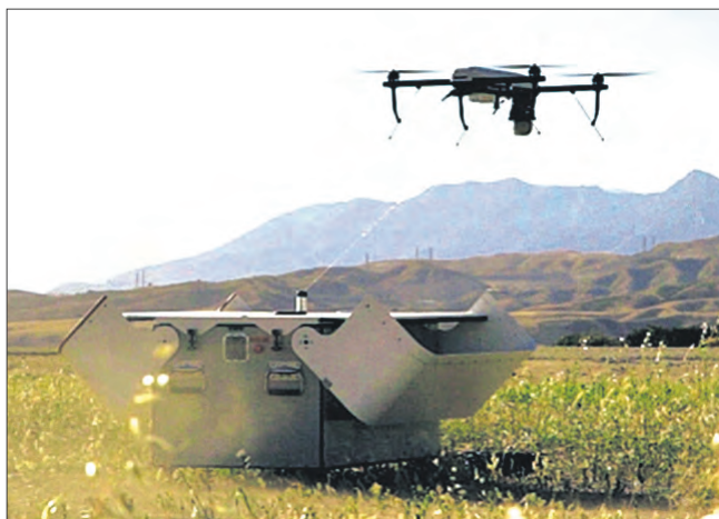
Роботизированный наблюдательный пункт на базе привязного квадрокоптера «Тезе Ай»
